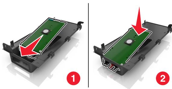
6 Prenda a solução ISP no suporte de plástico usando um parafuso longo.
